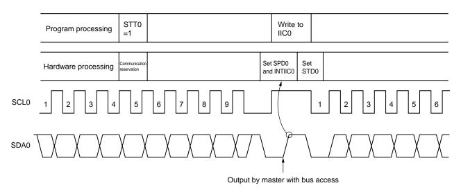
Remark IIC0 : IIC shift register
